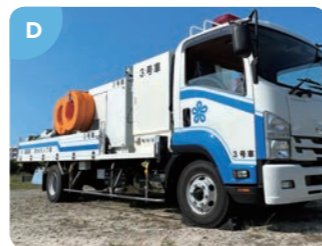
排水ポンプ車の外観
